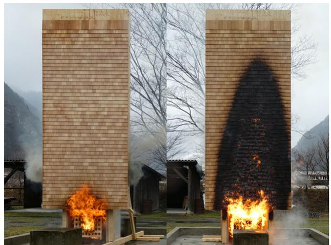
Ein Brandversuch der Schindelfassade
