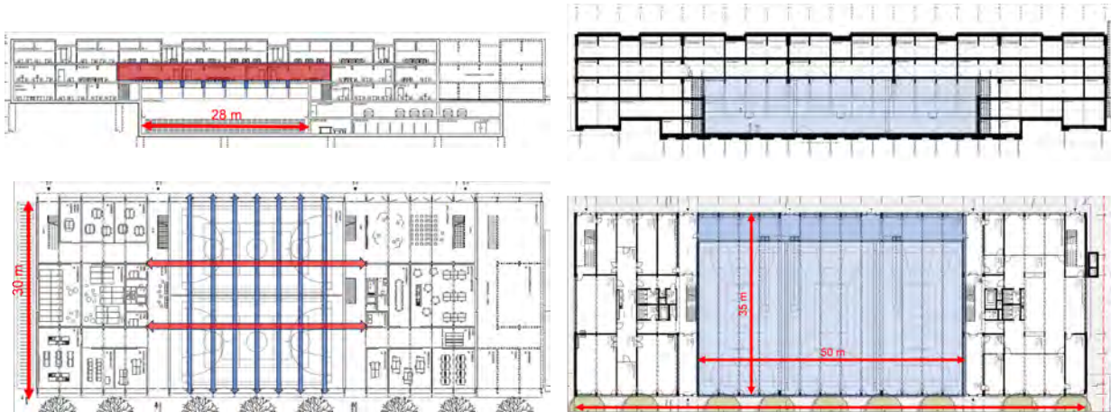
Abb. 1: Projektkonzept der Schule Wiesenthal in der Wettbewerbsphase (links) und der Projektierungsphase (rechts), jeweils der Schnitt in Längsrichtung und Grundriss mit Fokus auf die Turnhalle
