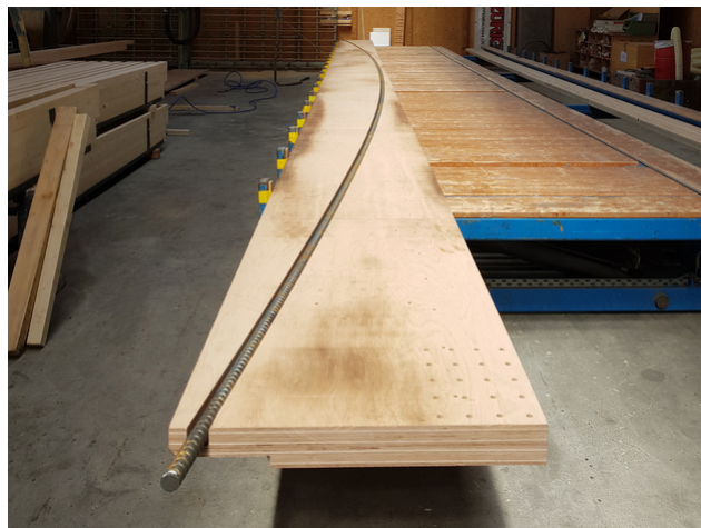
Im Detail: fischbauchförmig eingefräste Vorspannstange im Buchenträger
