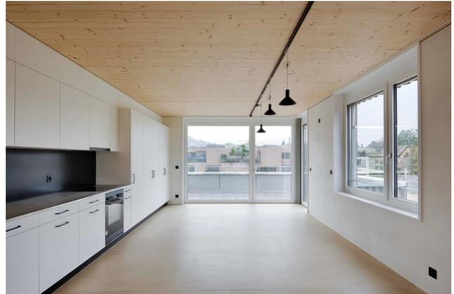
Der Ersatzneubau an der Wehntalerstrasse 52 in Zürich-Unterstrass ist aufgerichtet. Mit dem Einsatz von Lehmplatten, Schafwolldämmung, flexiblen Wänden und der TS3-Technologie ist der Holzbau aus ökologischer und technischer Sicht hoch interessant.
